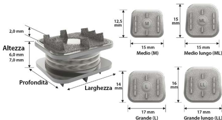
Figura 2: Dimensioni e altezze del disco cervicale artificiale M6-C
