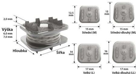
Obrázek 2: Výška a půdorys umělé krční ploténky M6-C
