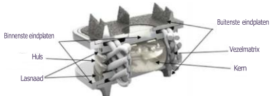
Afbeelding 1: Dwarsdoorsnedeweergave van de M6-C kunstmatige cervicale discus
