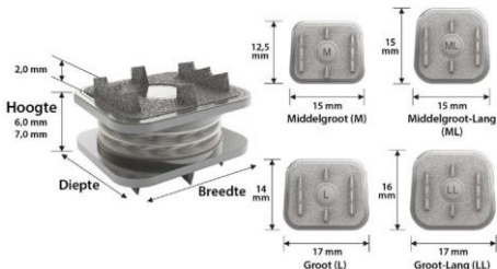
Afbeelding 2: Hoogten en voetafdrukformaten van de M6-C kunstmatige cervicale discus
