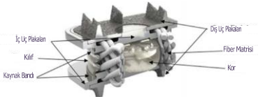
Şekil 1: M6-C Yapay Servikal Diskin Kesit Görünümü
