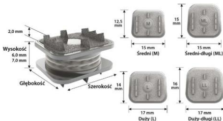
Rysunek 2: Wysokości sztucznego krążka szyjnego M6-C i wielkości blaszek granicznych
