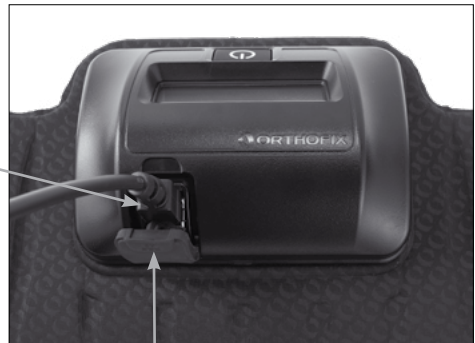
Cubierta del puerto de carga
